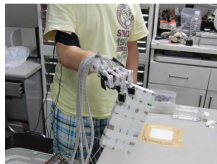
図 2, 電気通信大学の多自由度・高出力な筋電義手
