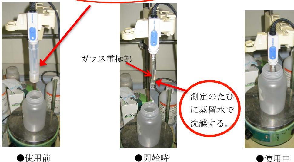
図4 pH メーター操作法とガラス電極による pH 測定の様子
