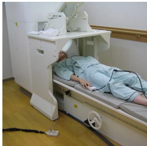
図2：脳磁場計測装置を用いた実験 (実験協力：ATR・Promotions 脳活動イメージングセンター)
